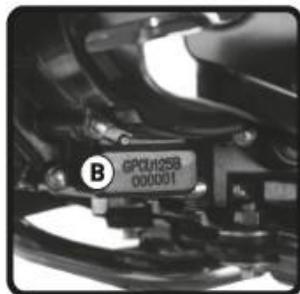
2. エンジンの製造コード番号は、ギア・レバー・ペダル(B)に型押ししている。
