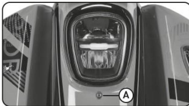
ビームが低すぎると、夜間走行には安全ではなく、また高すぎるビームは、他のドライバーの目をくらませる可能性がある。従って、ヘッド・ライト調整ネジ(A)を調整して、ヘッド・ライトを正しく照準すること。
