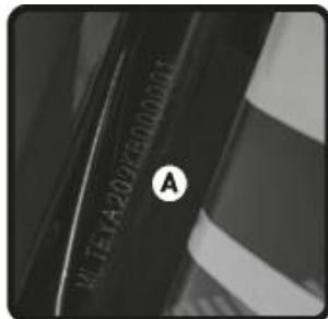
1. 車台の識別コード番号は、ステアリング・ネック(A)の左側に型押ししている。
